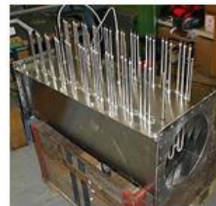
Lufterhitzer bis 300°C komplett aus Chromstahl
