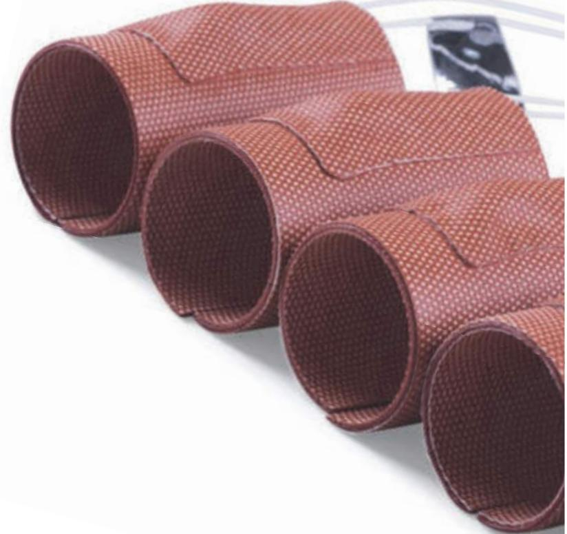
Vorgeformte Heizgeräte bestehen aus gleichmäßig angeordneten Widerstandsdrähten oder chemisch geätzten Folienbahnen, die zwischen Silikonkautschukplatten laminiert sind, um Rohre mit kleinem Durchmesser zu beheizen.
